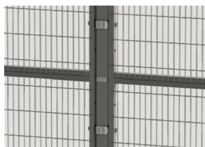
SMART SPLICE Snelle koppeling voor hoge staanders. De Smart Splice past in de 60x40 staander.
