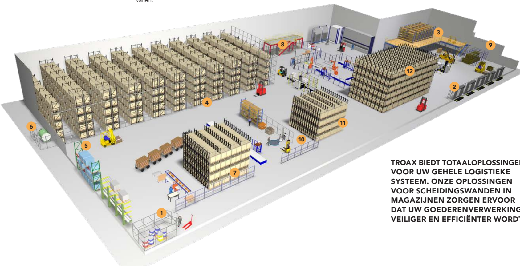
3 MEZZANINE HANDRAIL Het mezzaninesysteem met staanders, panelen, plinten en handrail beschermt zowel mensen als losse onderdelen tegen het naar beneden vallen.
