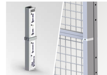
5 SMART SPLICE Die Stützenverlängerung wird für Trennwände verwendet, die höher als 3000 mm sind. Sie ist kompatibel mit den Standardpfosten 60x40 und Rohren in pulverbeschichteter Ausführung.
